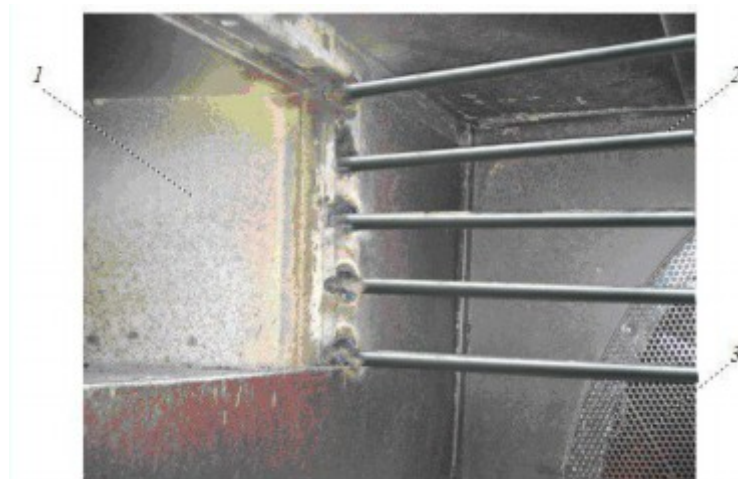
2-расм. Йўналтиргич ўрнатилган сепаратор ишчи камераси: 1— кириш қузури; 2 — йўналтиргичлар; 3 — тўрли юза
