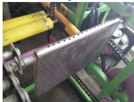
Рис. 2. Виды опорной плиты (а) и способ её крепления на тяговых цепях (б)
